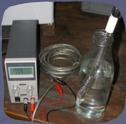
Teststation: Leitungswasser mit Doppelhelix-Lampe
